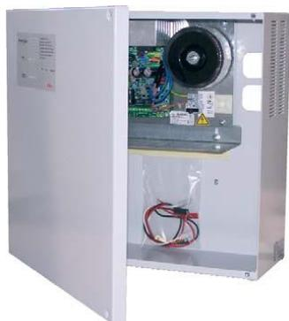
Ai fini della sicurezza dovrà essere dotata di trasformatore di disaccoppiamento dalla rete elettrica e, sul frontale del contenitore serigrafia con due led che, in funzione del loro stato (acceso, spento o lampeggiante), segnalino le condizioni di funzionamento dell'unità. Dotata di 2 uscite di alimentazione distinte ognuna protetta indipendentemente contro il sovraccarico, il cortocircuito e l'inversione di polarità.
