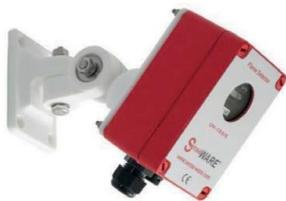
Rivelatore di fiamma ad ultravioletti (UV) gestito da algoritmo di analisi basato su microprocessore tipo “910800C” della DEF o equivalente. Adatto per proteggere depositi di combustibili, di solventi e di sostanze chimiche, aree con motori a benzina, laboratori ma anche per realizzare “protezioni ad oggetto” di specifici apparati, in grado di rivelare fiamme generate dalla combustione di idrocarburi semplici, come metano e metanolo, ma anche
